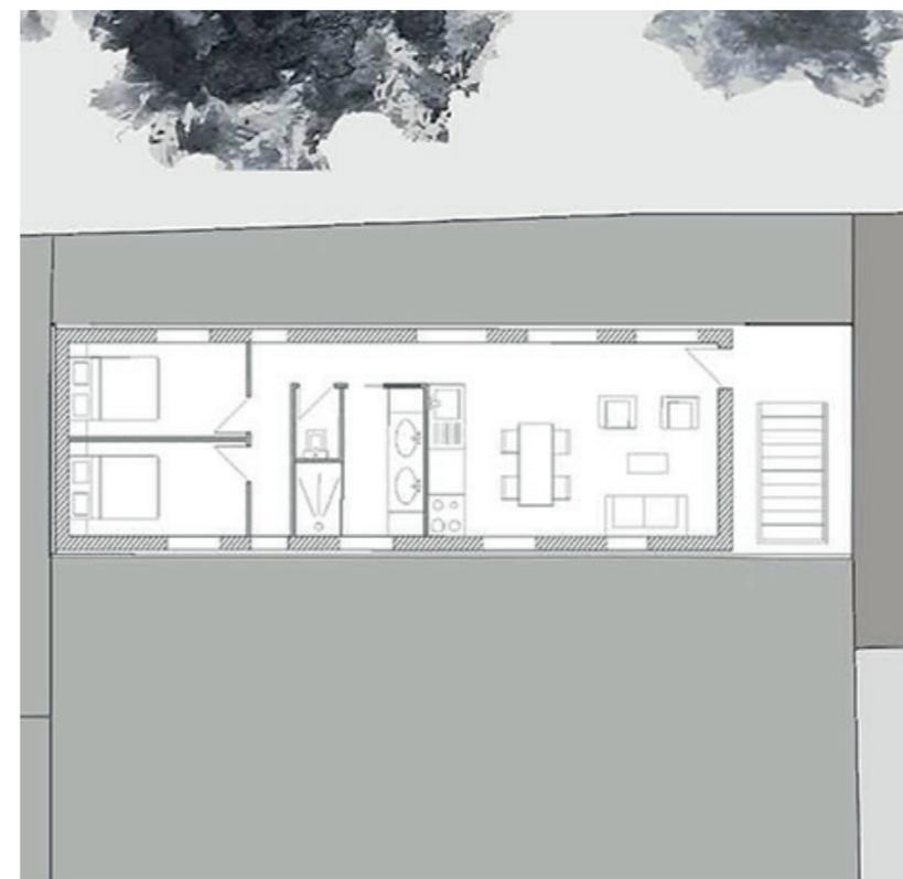
Plan du R+2 au niveau de la surélévation
