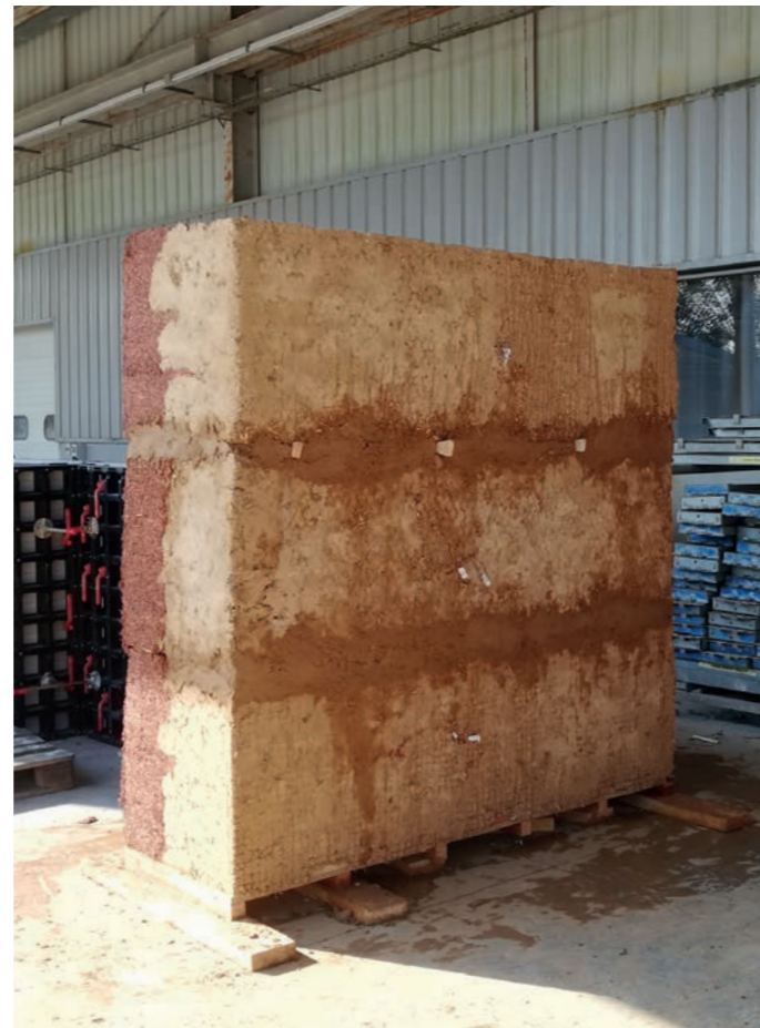
Fig.12 - Résultat de l'expérimentation du mur CobBauge des élèves du Lycée technique Laplace de Caen en 2020
