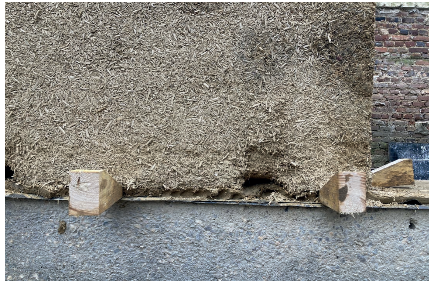
Fig.38- Arrête abîmée sur la terre allégée du mur CobBauge lors du levage
