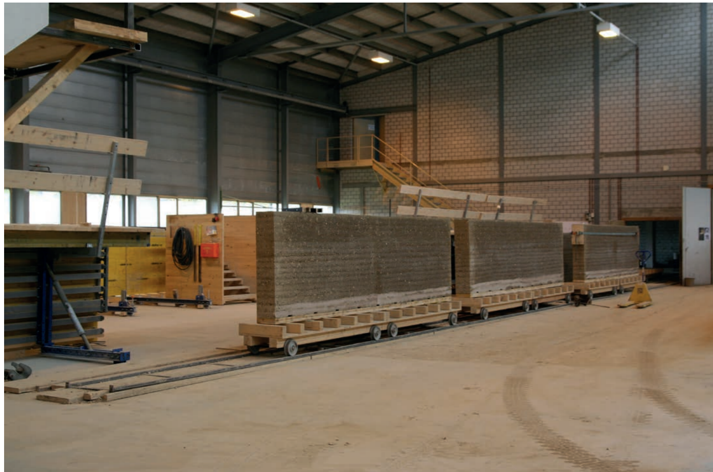
Fig.16 - Usine de préfabrication de Laufen mise au point par Lehm Ton Erde
