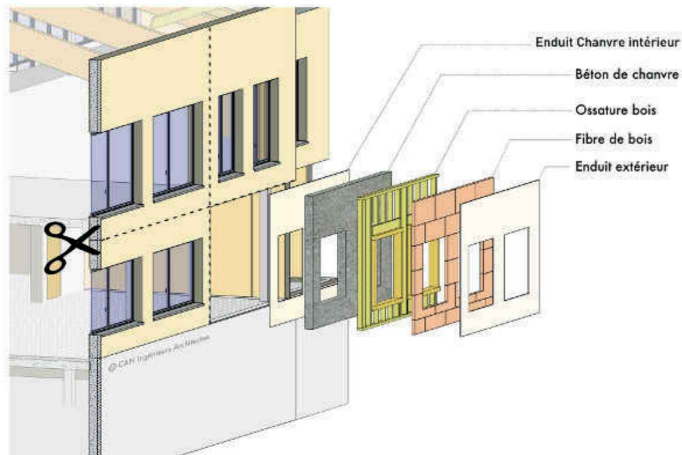
Fig.24 - Schéma de composition des panneaux préfabriqués des bureaux à Noyal-sur-Vilaine par Koutev Architecture
